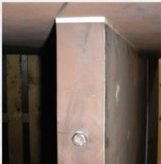
Заменяемые уплотнения заслонки уменьшают пыление
