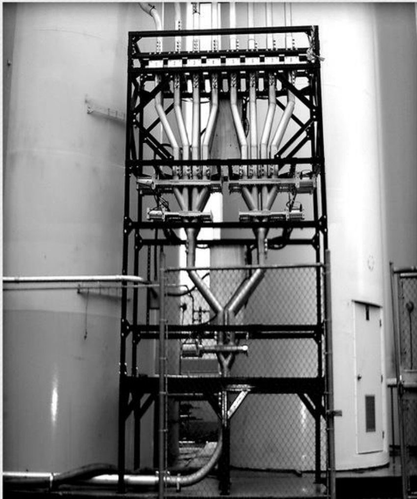
Дивертер 2x8 над работает с пластикатом
