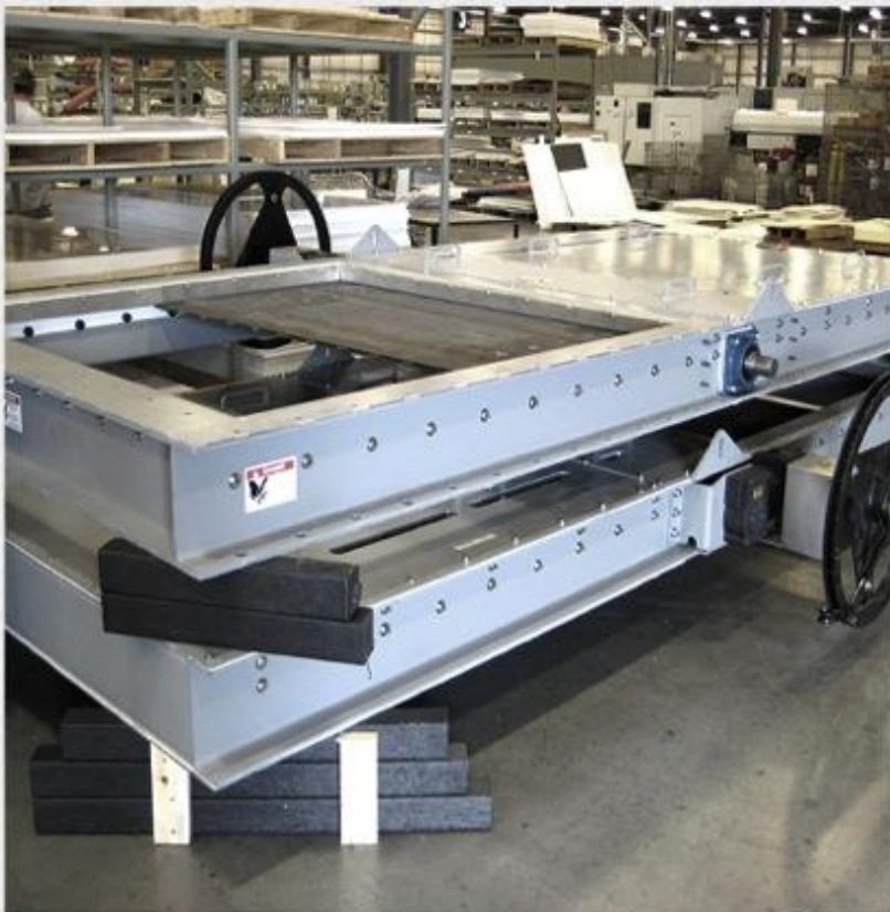
Задвижка 72" (1829мм) работает с углем
