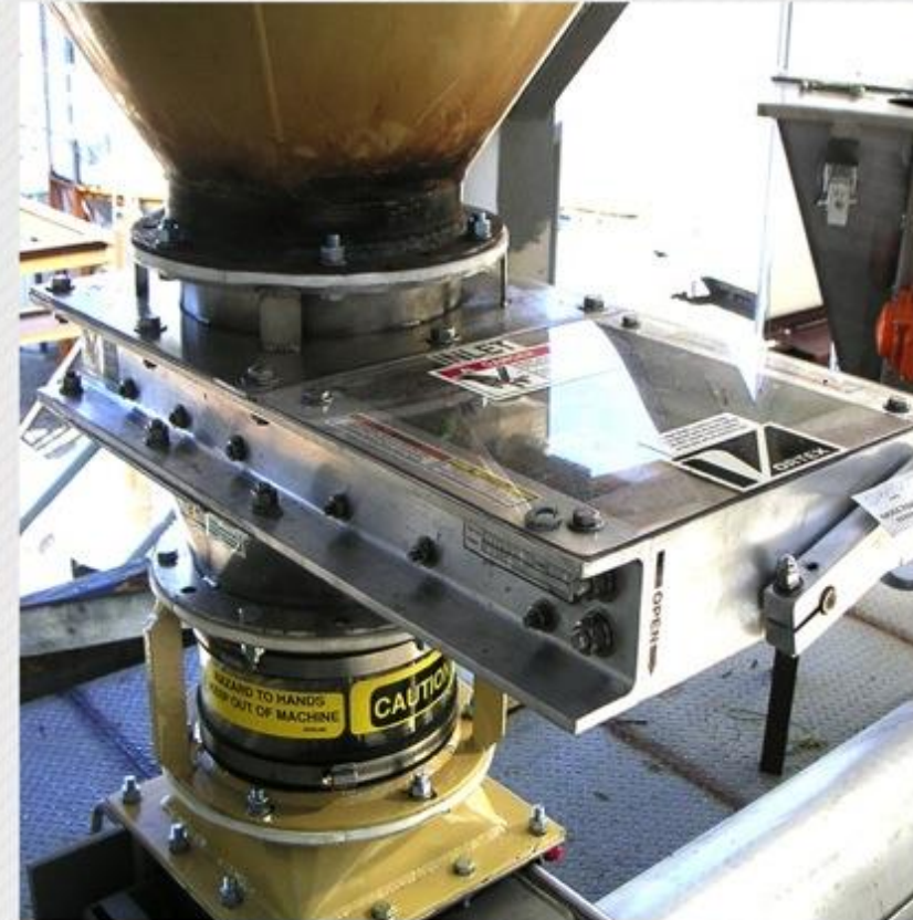
Задвижка 10" (254мм) работает с поливинилхлоридной смолой
