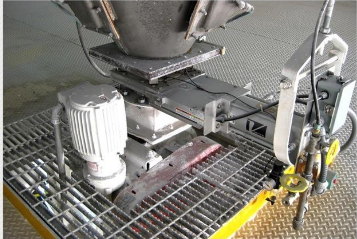
Задвижка 12" (305мм) установлена над шлюзовым питателем, транспортирующим карбонат кальция
