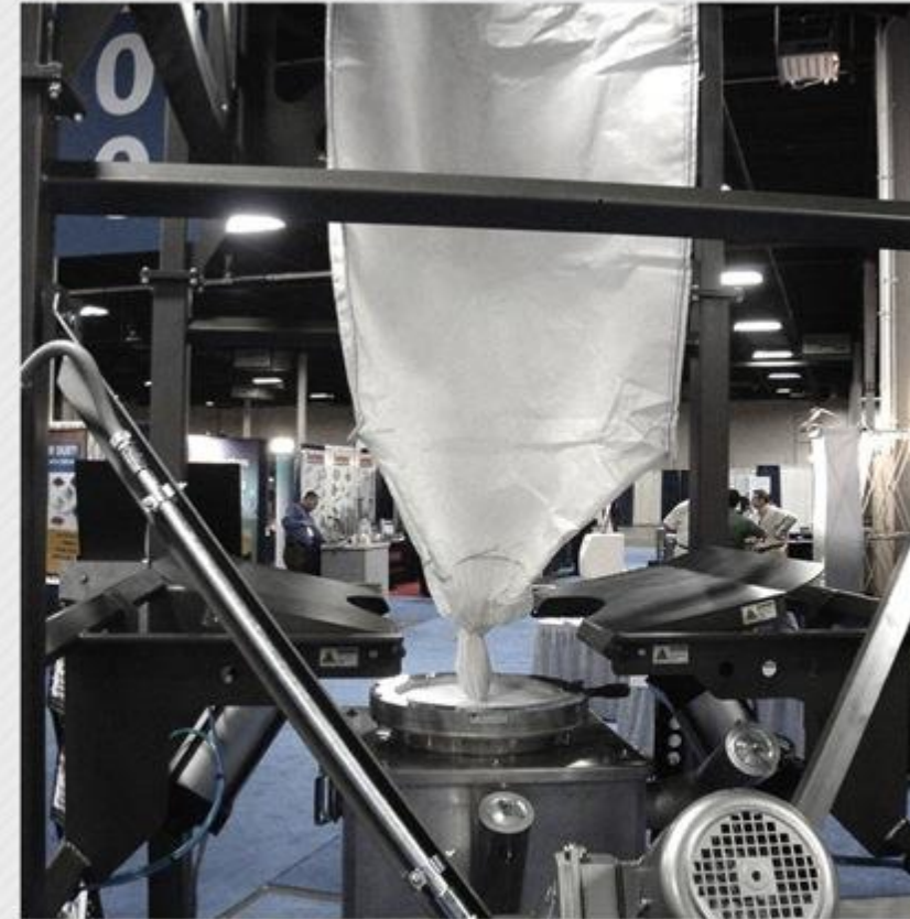
Задвижка 15" (381мм) работает на разгрузке биг-бэга
