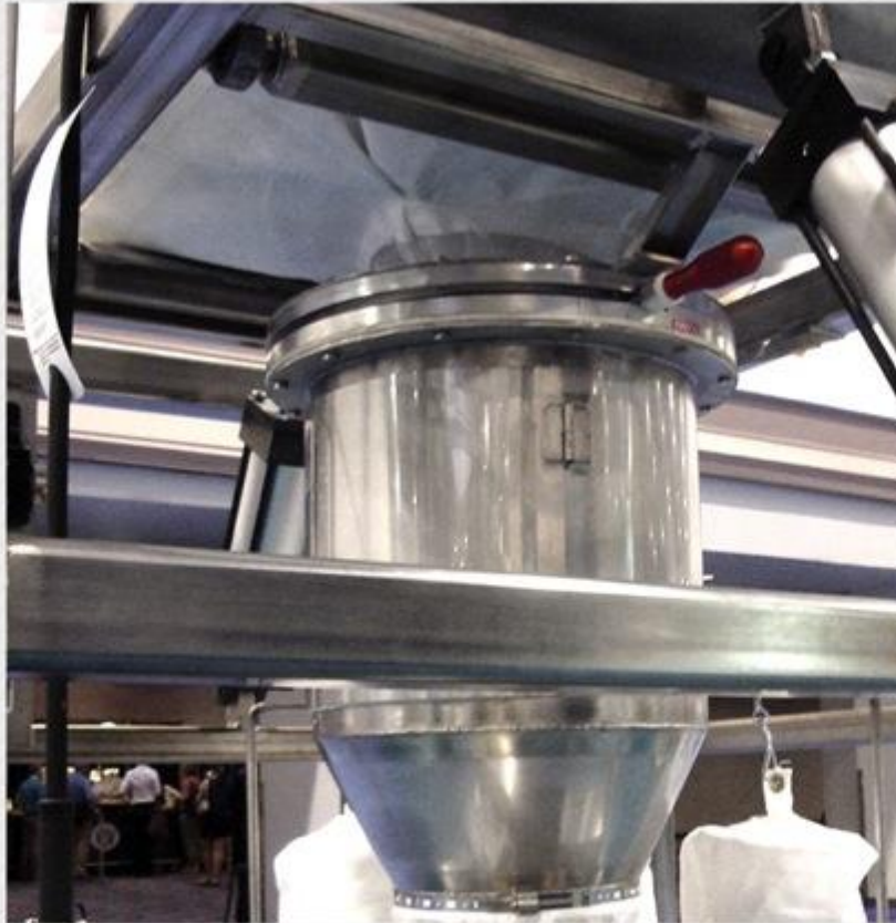
Задвижка 18" (457мм) работает на разгрузке биг-бэга
