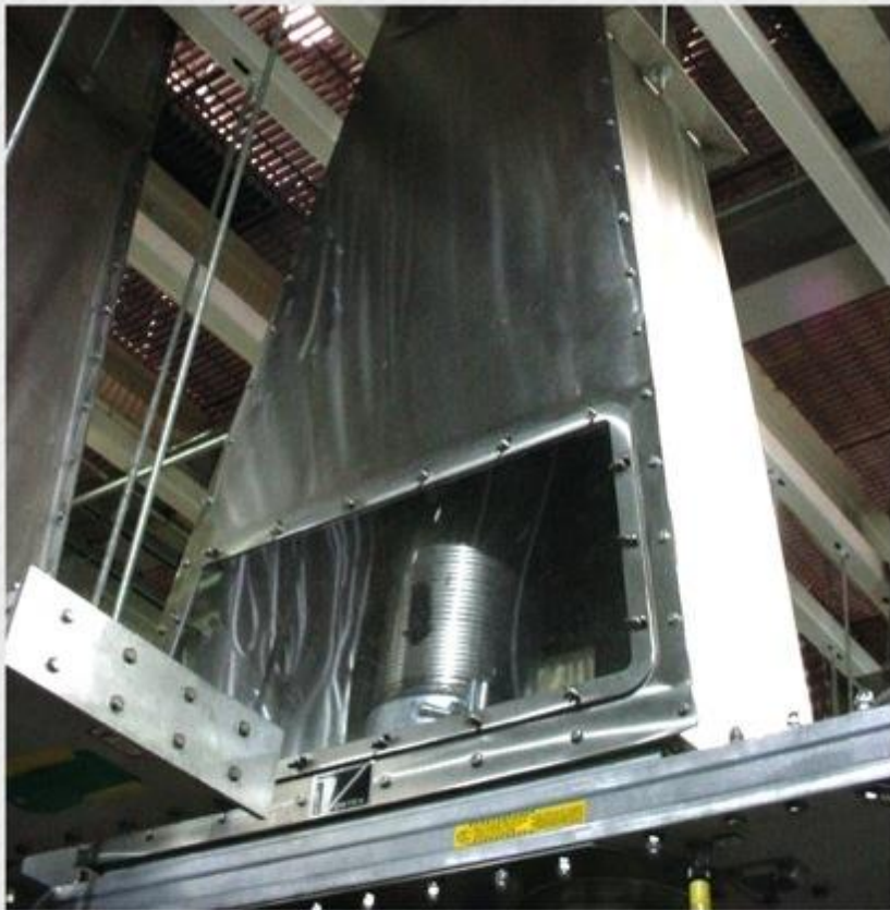
Дивертер 8" (203мм) работает с пластиком
