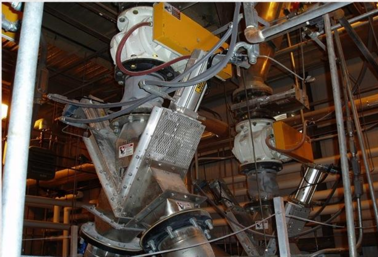
Дивертер 8" (203мм) под шлюзовым питателем, транспортирующим оксид цинка
