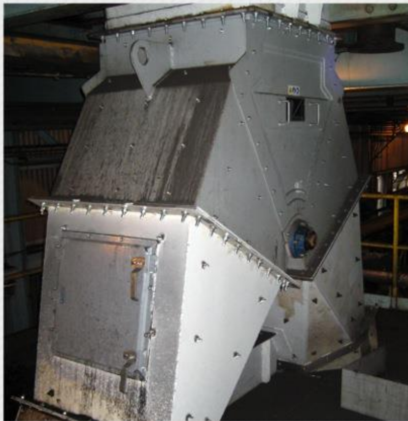
Дивертер 56" (1422мм) работает с углем
