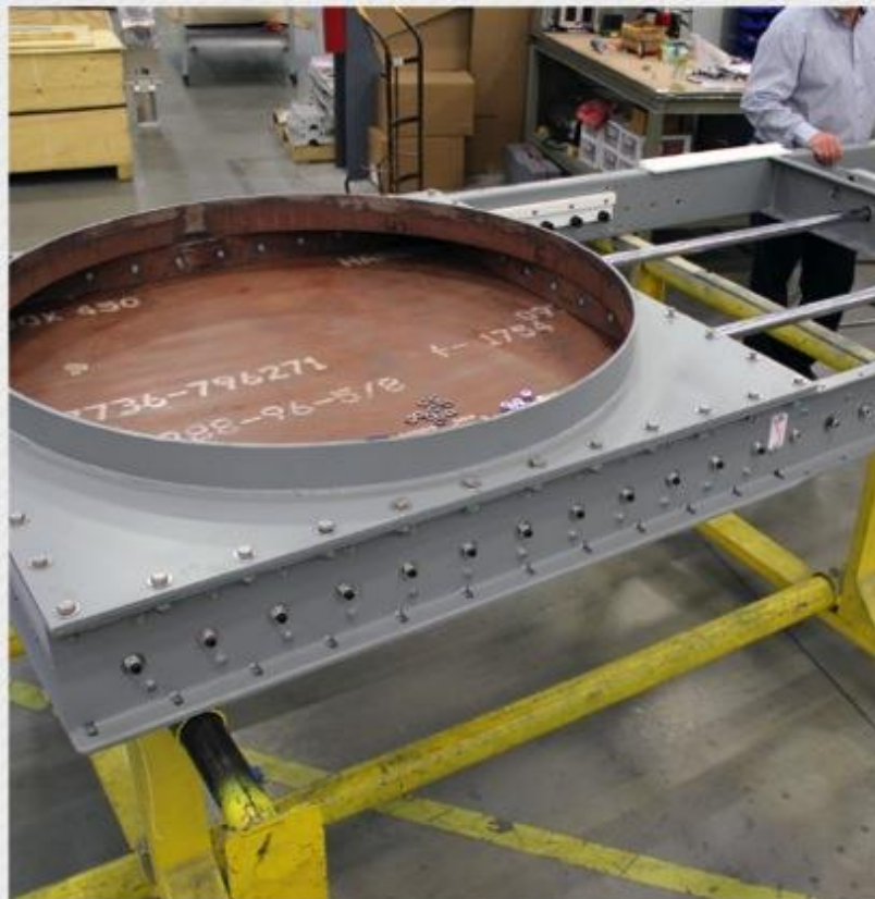
Задвижка 48" (1219мм) работает с бентонитом
