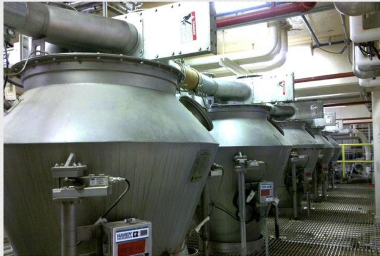
Дивертер 6" (152мм) над весовым ковшом работает с пекарной смесью
