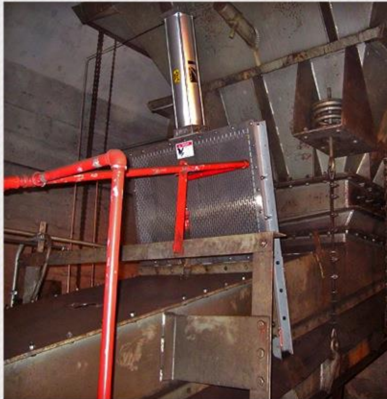
Задвижка 610мм x 965мм установлена в системе вибропитателя для дозирования потока угля
