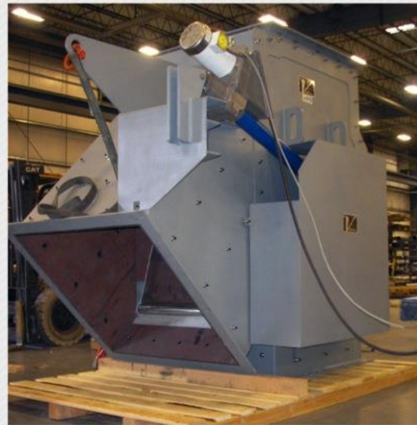
Дивертер 62" (1575мм) работает с стеклобоем
