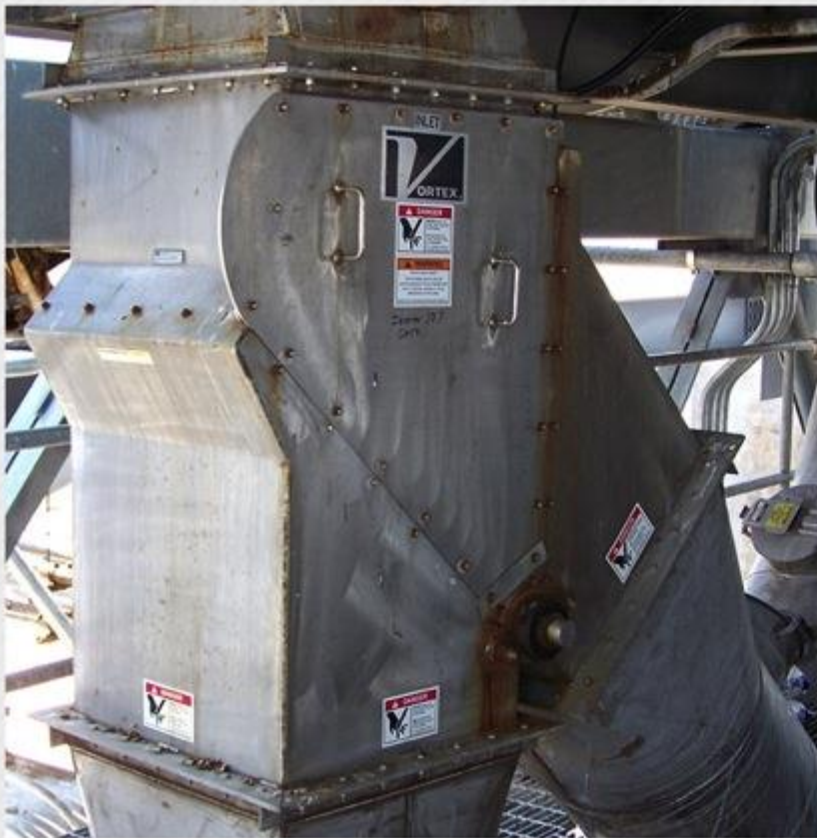
Прямолинейный дивертер 24" (610мм) работает с зерном
