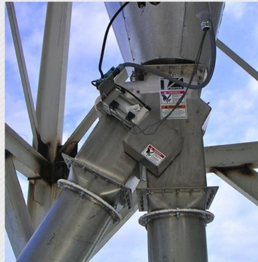
Прямолинейный дивертер 10" (254мм) работает с каолиновой глиной
