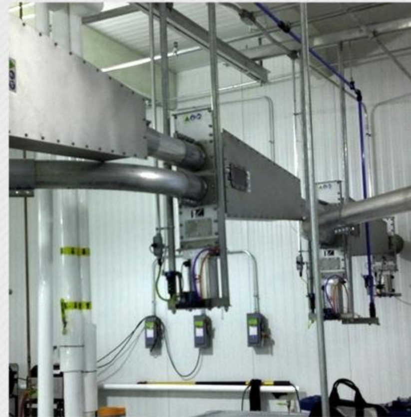
Дивертер 6" (152мм) работает с кофейными зернами
