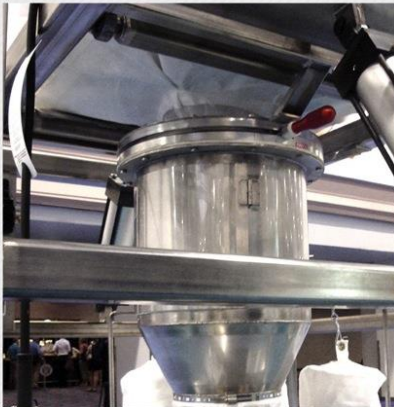
Задвижка 18" (457мм) работает на разгрузке биг-бэга
