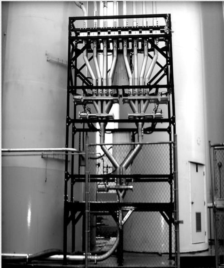
Дивертер 2x8 над работает с пластиком
