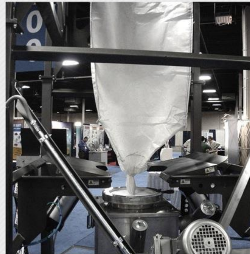
Задвижка 15" (381мм) работает на разгрузке биг-бэга
